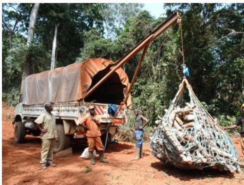
Figure 2 : camion transformé par Pallisco pour les travaux de terrain
